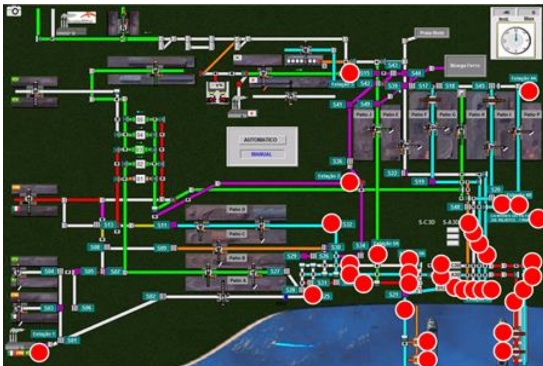
Sinais vermelhos apontam locais com presença de aspersão de água no transportador (aspersores de chute, aspersores sobre e sob correia)
