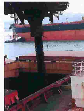
Figura 49 – Carregamento de minério (pellet feed) em navio com projeção de material
