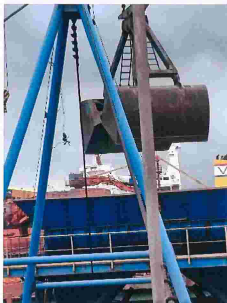
Figura 57 – Descarregamento de fertilizante do navio com grab sem controle
