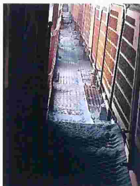
Figuras 43 e 44 - Detalhamento de esteiras sem bandejamento inferior com acúmulo de pó na lateral
