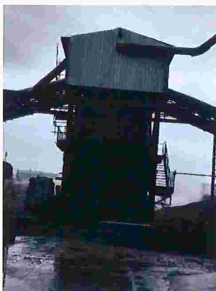
Figura 15 – Peneira de classificação de pelotas já queimadas
