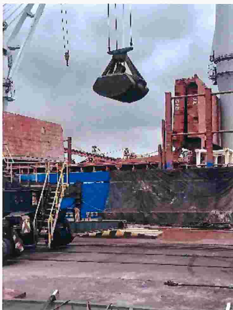
Figura 54 – Lona no costado do navio para evitar queda de material no mar descarregado pelo grab
