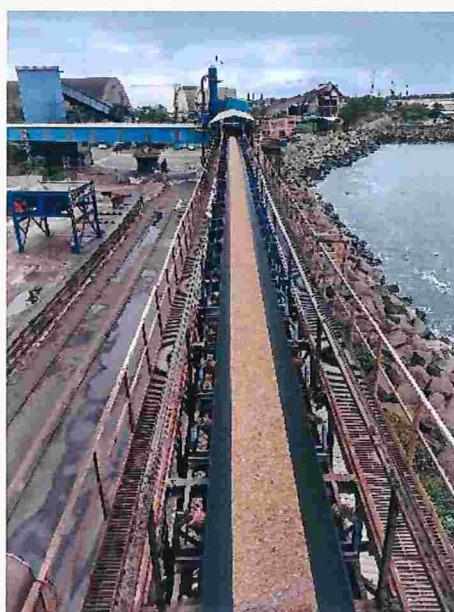
Figura 59 – Correia transportadora da descarga de fertilizante sem controle
