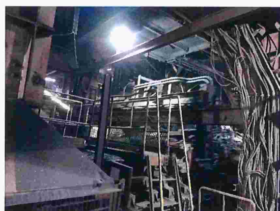
Figura 18 – Detalhe de acúmulo de pó no interior da área de classificação de pelotas da Usina 3
