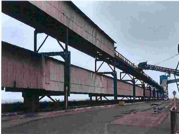
Figura 52 – Correias transportadoras sem bandejamento inferior
