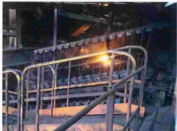
Figura 40 – Peneira de classificação de pelotas verdes antes da entrada do forno
