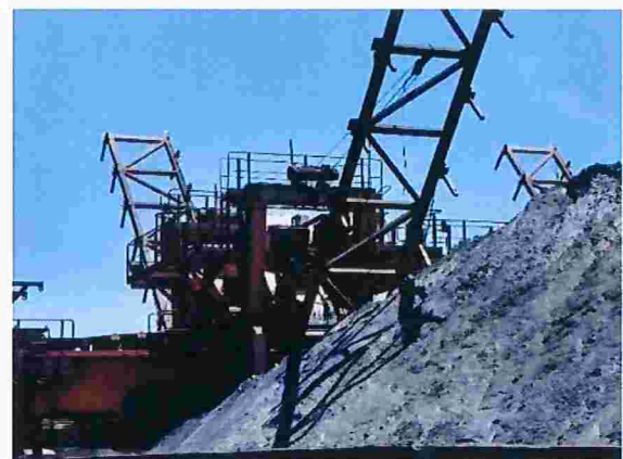
Figura 86 – Detalhe do reclaimer (Pátio L)
