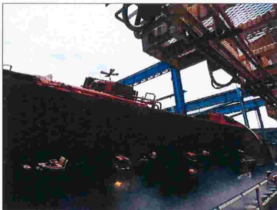
Figura 79 – Basculamento do vagão com aspersão de água
