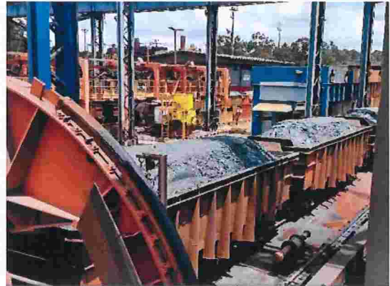
Figura 72 – Vagão após aspersão de água + polímero
