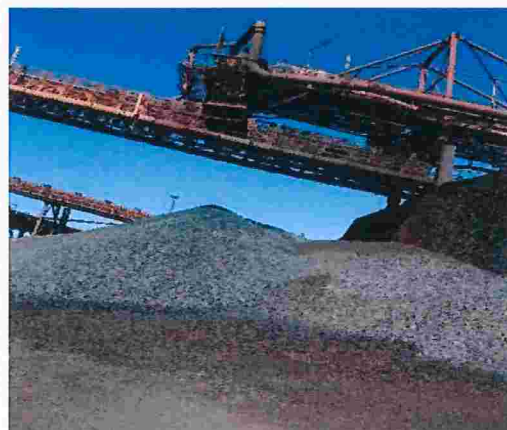
Figura 138 – Dispositivo de descarregamento das pelotas sem classificação
