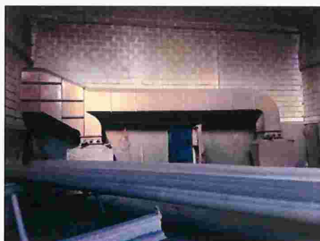
Figura 193 – Interior da cabine de jateamento com sistema de captação
