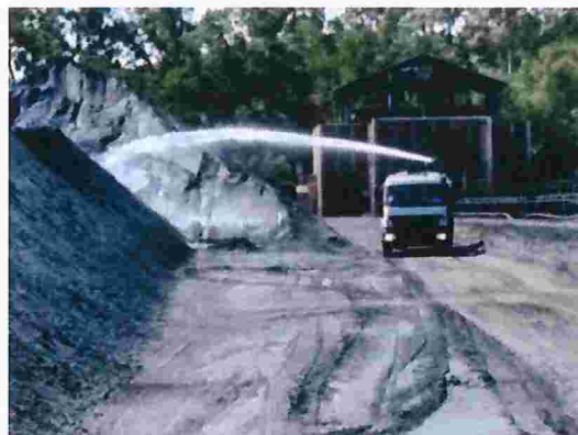
Figura 94 – Umectação de pilhas com caminhões
