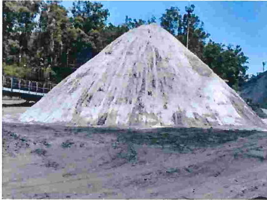
Figura 87 – Pilha sem identificação e sem contenção (Pátio M)
