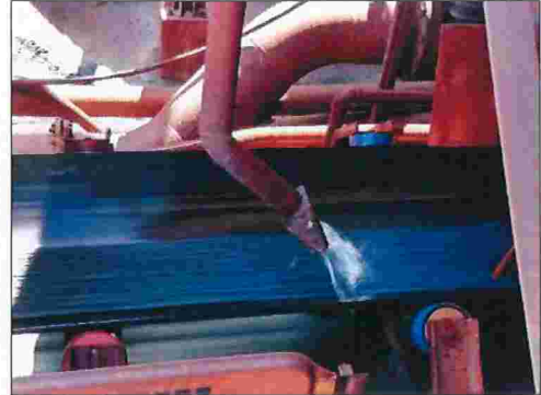
Figura 98 – Aspersão de água na esteira para resfriamento de pelotas
