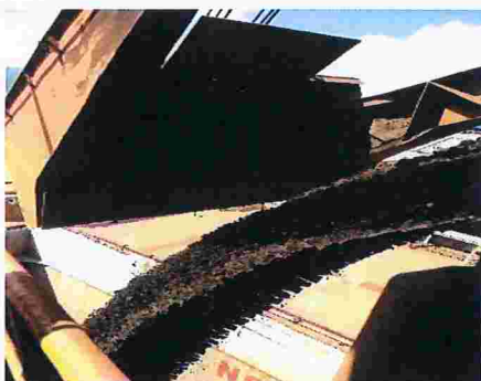
Figura 53 – Carregamento de sinter feed no navio sem aspersão de água
