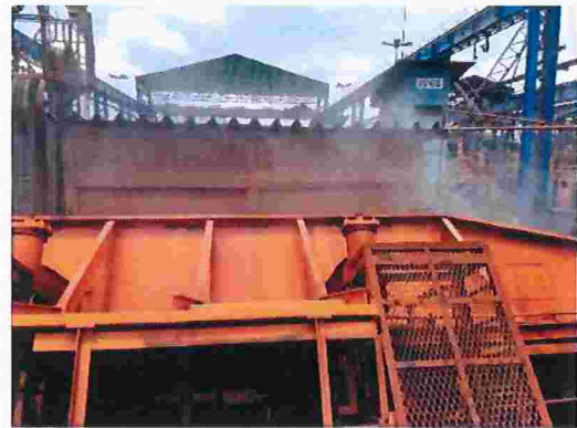
Figura 74 – Emissão fugitiva durante o basculamento do vagão
