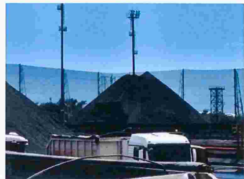
Figura 14 – Detalhe do carregamento de carvão em caminhão sem emissão (material úmido)
