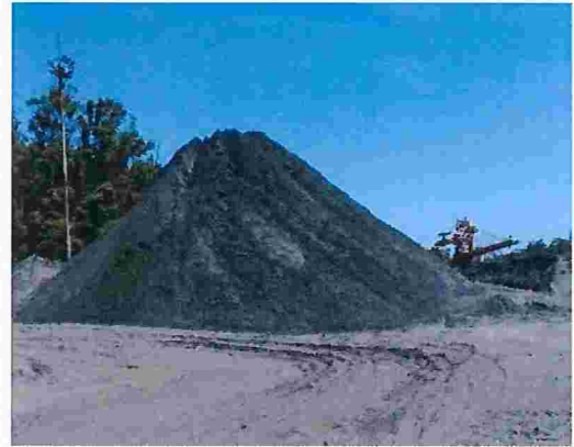
Figura 88 – Pilha sem identificação e sem contenção (Pátio M)
