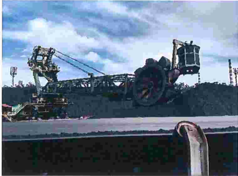
Figura 15 – Recuperação das pilhas com reclaimer com deposição do material em correia própria
