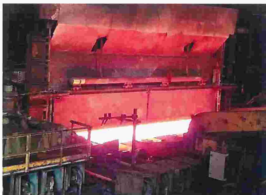
Figura 65 – Detalhe do desenformamento sem emissão visível
