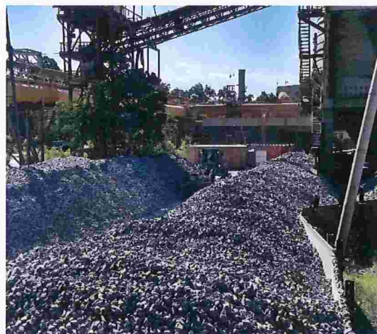
Figura 99 – Pátios com material sem identificação e delimitação física de pilhas, com movimentação por pá carregadeira.
