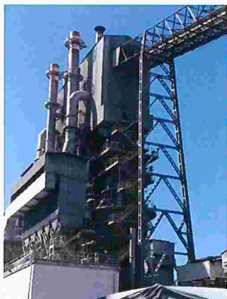
Figura 104 – Detalhe do forno de calcinação provido de filtro de mangas
