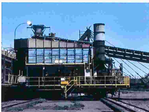
Figura 94 – Máquina enforadora de carvão provida de filtro de mangas
