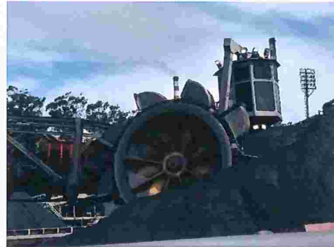
Figura 16 – Detalhe do reclaimer para recuperação de pilhas
