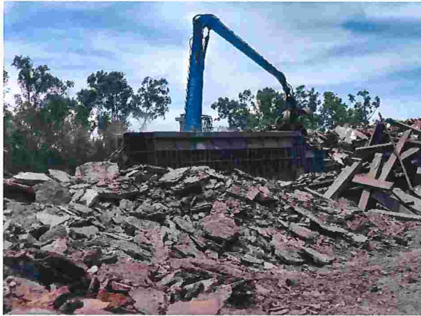
Figura 35 – Transferência de pilhas de sucata e escória para contêiner para alimentação do convertedor da aciaria
