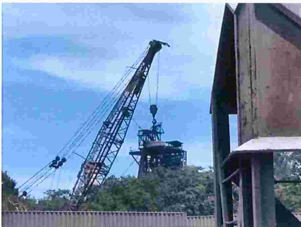
Figura 33 – Uso de guindaste para fragmentar escória de grandes dimensões (body)
