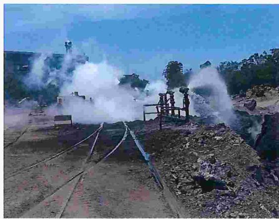
Figura 30 – Detalhe das emissões do resfriamento da escória no pátio
