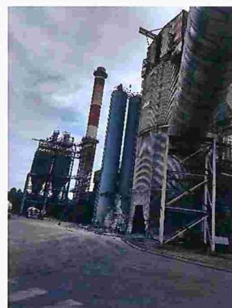
Figura 39 – Lavador com lama de cal, filtro de mangas e expedição do material coletado
