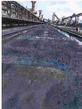
Figura 26 – Detalhe do piso da área da bateria de fornos com material depositado
