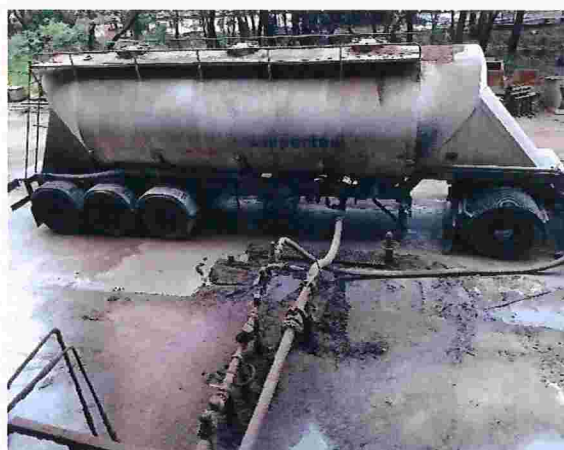
Figura 79 – Caminhão de transferência de pó de aciaria para silo
