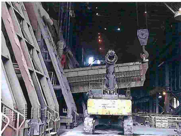
Figura 65 – Alimentação de sucata de aciaria nos convertedores
